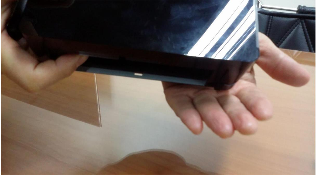
**step3.** 아래 후크가 바깥쪽으로 당겨진 상태에서 아래 사진과 같이 s50본체를 가볍게 위쪽으로 두드려 줍니다.(이때 내부의 스프링으로 인해 하드디스크가 갑자기 튀어 나올수 있으니 하드디스크 파손과 부상 방지를 위해 높지 않고 딱딱하지 않는 바닥에서 하기 바랍니다.)
